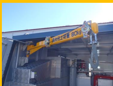
クレーン(吊上げ荷重80Kkg)
